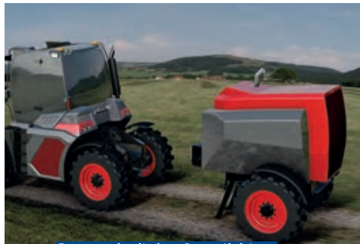
Powerpack mit einer Gesamtleistung von 1300 PS
