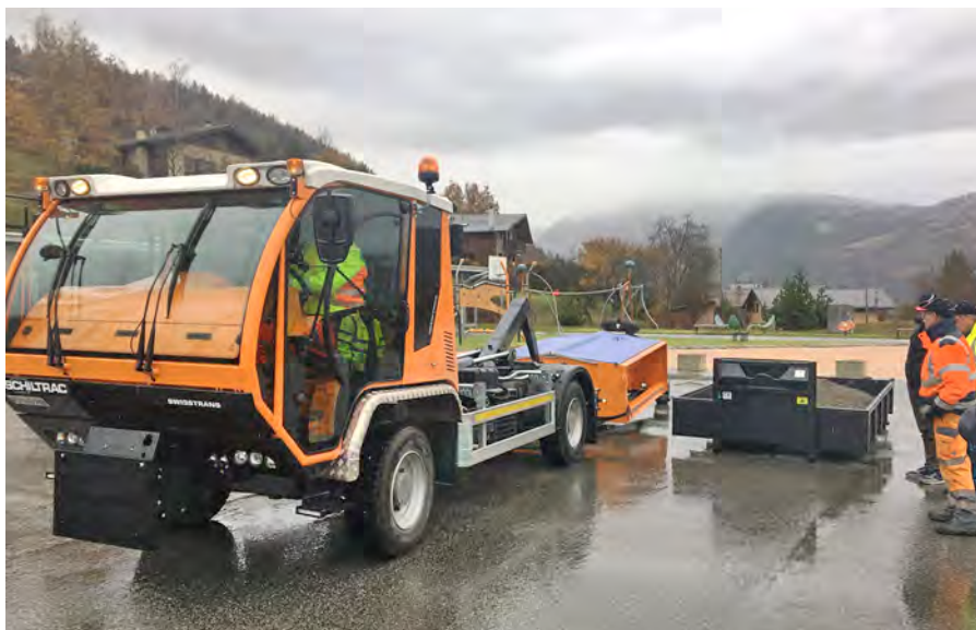
Für Flexibilität sorgt bei kommunalen Aufgaben das bewährte Hakenlift-System.
