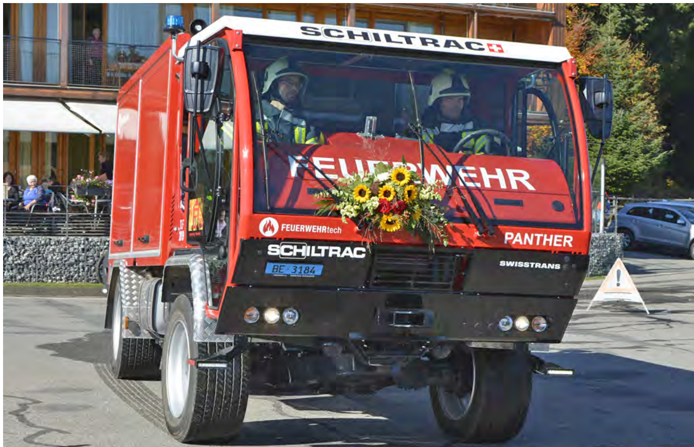
Das Tanklöschfahrzeug der Feuerwehr Buchholterberg-Wechseldorn im Berner Oberland ist der Swisstrans von Schiltrac. In den hügeligen Regionen der Voralpen ist die Geländegängigkeit von besonderer Bedeutung. Der Fahrzeugaufbau wurde eigens von der Martin Rohrer V & R GmbH angefertigt.
