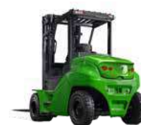
B800 Tragkraft: 8t auf 900mm Hubhöhe: 3,3–7m Antriebsart: Elektro
