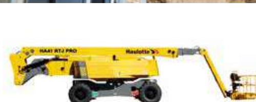
HA32/41 RTJ PRO Arbeitshöhe: 32–41 m Tragkraft: 230–250 kg Antriebsart: Diesel Einsatzgebiet: aussen
