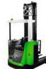
R100 Tragkraft: 1,2–1,6t Hubhöhe: 3–8,5m Antriebsart: Elektro
