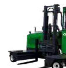
C2500–C4000 ST/E Tragkraft: 2,5–4 t Hubhöhe: 4–7,5 m Antriebsart: Gas/Elektro
