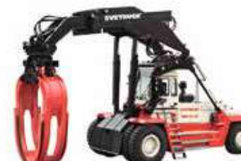
TMF 12/9-28/21 Holzgreifer Greifergrösse: 2,3–9,5m² Antriebsart: Diesel
