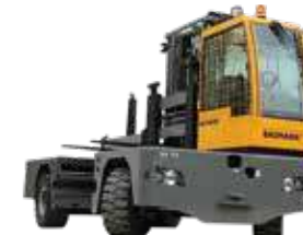
GX 50–80 Tragkraft: 5–8 t Hubhöhe: 3,5–8,1 m Antriebsart: Diesel
