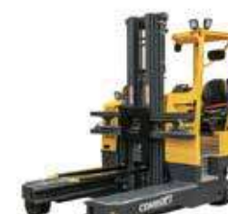
MR4 Tragkraft: 2,5–3t Hubhöhe: 4–8,4m Antriebsart: Elektro
