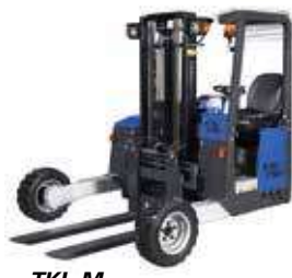
TKL-M Tragkraft: 2–2,5 t Hubhöhe: 2,8–4,05 m Antriebsart: Diesel
