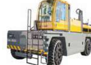
GXS 200/GXS 250–500 Tragkraft: 20–50 t Hubhöhe: 3–6,5 m Antriebsart: Diesel
