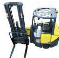
Aisle Master AM Tragkraft: 1,5–3t Hubhöhe: 4,3–15m Antriebsart: Elektro
