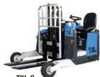
TKL-S Tragkraft: 1,2–2 t Hubhöhe: 1,8–3,2 m Antriebsart: Diesel
