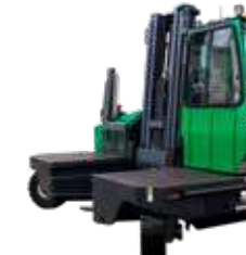
C4500SL–C6000SL/E Tragkraft: 4,5–6 t Hubhöhe: 4–6,3 m Antriebsart: Diesel/Gas/Elektro
