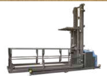
Order Picker OP Tragkraft: 0,5–2t Hubhöhe: 7,5m Antriebsart: Elektro
