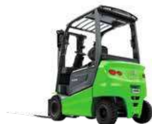
B600 Tragkraft: 2–5t Hubhöhe: 3–6,5m Antriebsart: Elektro
