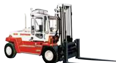
1560-33-1875-33 Tragkraft: 12–18t Hubhöhe: 3–7m Antriebsart: Diesel
