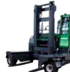
C6000–C12000/E Tragkraft: 6–12 t Hubhöhe: 4–7,4 m Antriebsart: Diesel/Gas/Elektro
