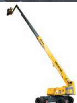
HT43RTJ PRO Arbeitshöhe: 43 m Tragkraft: 450 kg Antriebsart: Diesel Einsatzgebiet: aussen
