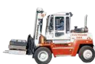
1060-28-1460-33 Tragkraft: 10–14t Hubhöhe: 3–7m Antriebsart: Diesel
