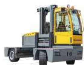
ELX 30–50 Tragkraft: 3–5 t Hubhöhe: 3,3–7,5 m Antriebsart: Elektro
