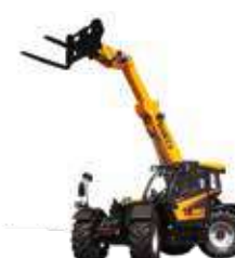
Agri Plus Tragkraft: 4–4,2 t Hubhöhe: 7,2–9,6 m Antriebsart: Diesel
