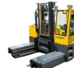
ESL Tragkraft: 6–9t Hubhöhe: 4–9,4m Antriebsart: Elektro
