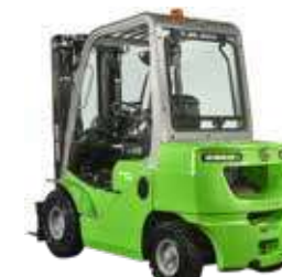
M300 Tragkraft: 1,5–3,5t Hubhöhe: 3–7m Antriebsart: Diesel/Gas
