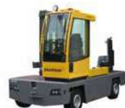
HX 30–40 Tragkraft: 3–4 t Hubhöhe: 3,3–7,5 m Antriebsart: Diesel
