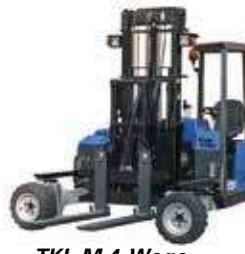
TKL-M 4-Wege Tragkraft: 2–2,5 t Hubhöhe: 2,8–4,05 m Antriebsart: Diesel
