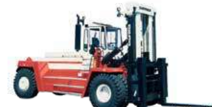
32120-48-52120-60 Tragkraft: 32–52t Hubhöhe: 3–13,8m Antriebsart: Diesel
