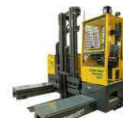
MR4 Tragkraft: 3,5–4,5t Hubhöhe: 4–8,4m Antriebsart: Elektro
