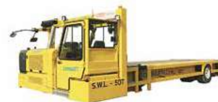
Swamp Body Transporter SBT Tragkraft: Bis 20t Antriebsart: Diesel
