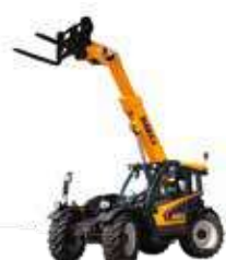
Agri Farmer Tragkraft: 3–3,4 t Hubhöhe: 6,4–8,7 m Antriebsart: Diesel
