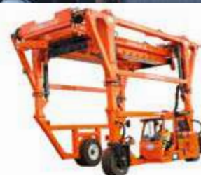
Straddle Carrier SC Tragkraft: 20–100t Hubhöhe: Container 2H Antriebsart: Diesel/Elektro
