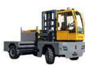
EGX 50–80 Tragkraft: 5–8 t Hubhöhe: 3,5–8,1 m Antriebsart: Elektro
