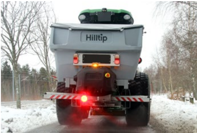
LED Arbeitsscheinwerfer (rot) und Warnlicht (orange)
