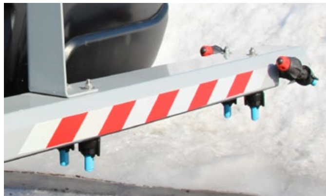
Doppelte Sprühdüsen für Enteisung selbst bei hohen Geschwindigkeiten
