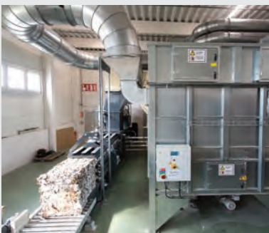
Ballenpresse für effiziente Verarbeitung von Stanzabfällen
