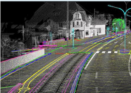
Auf Basis der 3D Mobile Mapping Daten erstellen wir ein präzises digitales Terrainmodell. Aus der Punktwolke digitalisieren wir von Hand Terrainpunkte sowie Bruchkanten und berechnen anschliessend das Terrainmodell. Die Daten werden in einem Standard CAD-Format abgegeben.
