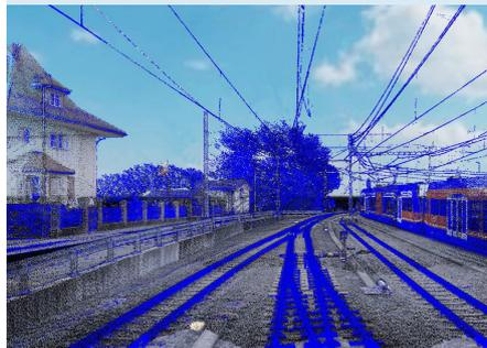
Die 3D-Punktwolke, welche georeferenziert und in Farbe zur Verfügung steht, hilft bei der Planung als zusätzliches Instrument. Mittels Spezialsoftware können Clash-Detection durchgeführt oder die Daten für Visualisierungen aufbereitet werden.
