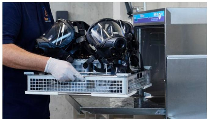
Bestückung der Maschine auf ergonomisch optimaler Höhe
