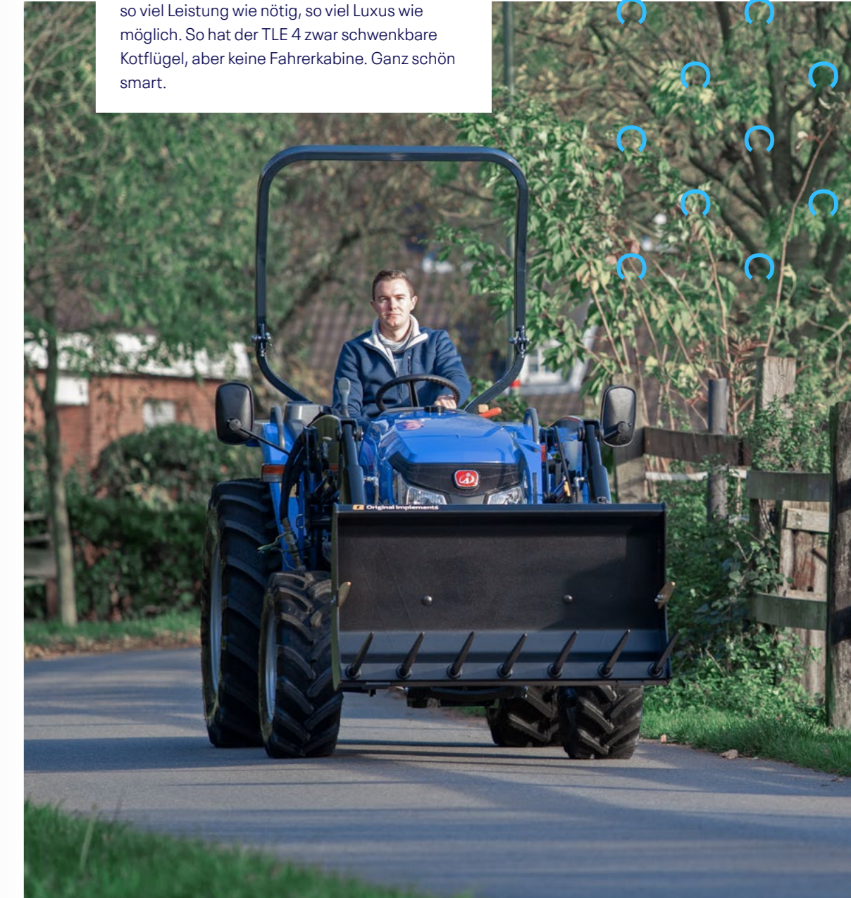
Kraftvoll von vorne bis hinten: vorn mit starkem 160-Frontlader, hinten mit 1.200 kg Hubkraft am Heck.
