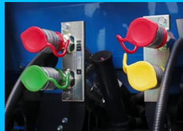
4 farblich gekennzeichnete Hydraulikanschlüsse der 2 serienmäßigen Steuerkreise
