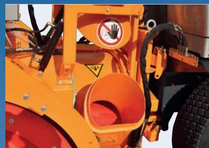
**Kamin direkt auf Drehschacht montiert.**
