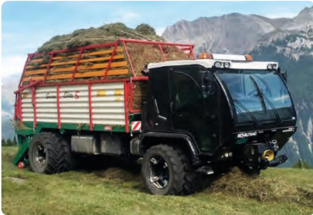
Mit Radstand 3950mm passt auch ein massgeschneidertes Ladevolumen bis 39 m³.
