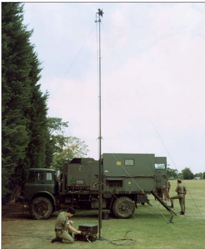
Foto: PU Mast auf freiem Feld, komplett ausgefahren und abgespannt.
