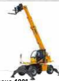
Pegasus 400° Tragkraft: 4–6 t Hubhöhe: 16–18 m Antriebsart: Diesel
