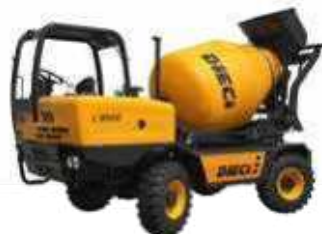
Betonmischer L3500 Wassertankvolumen: 630l Mischkapazität: 2,5 m³ Antriebsart: Diesel
