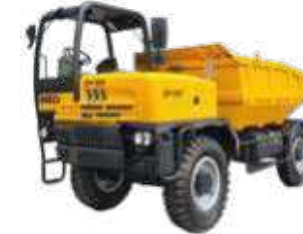
Dumper DP120 Nutzlast: 12t Fassungsvermögen: 7,5 m³ Antriebsart: Diesel
