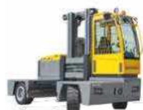
ELX 30–50 Tragkraft: 3–5 t Hubhöhe: 3,3–7,5 m Antriebsart: Elektro
