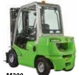
M300 Tragkraft: 1,5–3,5t Hubhöhe: 3–7m Antriebsart: Diesel/Gas
