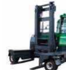
C14000–C25000 Tragkraft: 14–25 t Hubhöhe: 4,1–5,9 m Antriebsart: Diesel
