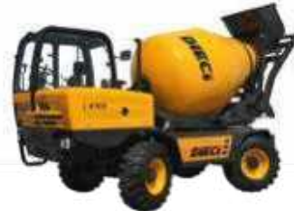
Betonmischer L4700 Wassertankvolumen: 630l Mischkapazität: 3,5 m³ Antriebsart: Diesel
