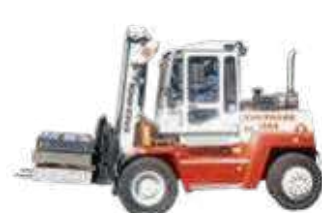
1060-28-1460-33 Tragkraft: 10–14t Hubhöhe: 3–7m Antriebsart: Diesel
