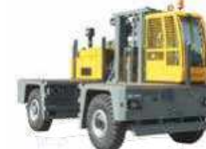
GS 80–180 Tragkraft: 8–18 t Hubhöhe: 3–6,5 m Antriebsart: Diesel
