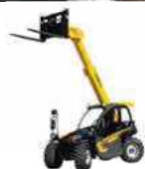
Mini Agri 26.6 Tragkraft: 2,6t Hubhöhe: 6m Antriebsart: Diesel
