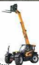
Zeus Tragkraft: 3,5–4 t Hubhöhe: 7,6–12,5 m Antriebsart: Diesel
