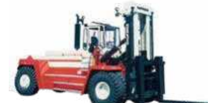
32120-48-52120-60 Tragkraft: 32–52t Hubhöhe: 3–13,8m Antriebsart: Diesel
