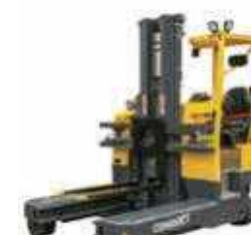
MR4 Tragkraft: 2,5–3 t Hubhöhe: 4–8,4 m Antriebsart: Elektro
