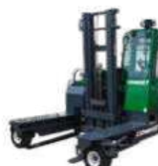
C3500–5000 / E, Tragkraft: 3–5 t Hubhöhe: 4–9,4 m Antriebsart: Diesel/Elektro
