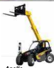
Apollo Tragkraft: 2–2,6 t Hubhöhe: 4,4–6 m Antriebsart: Diesel
