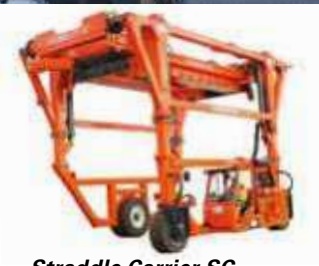
Straddle Carrier SC Tragkraft: 20–100t Hubhöhe: Container 2H Antriebsart: Diesel/Elektro
