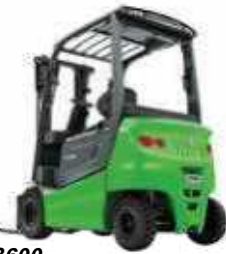
B600 Tragkraft: 2–5t Hubhöhe: 3–6,5m Antriebsart: Elektro
