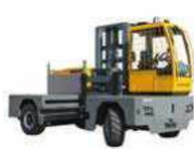
EGX 50–80 Tragkraft: 5–8 t Hubhöhe: 3,5–8,1 m Antriebsart: Elektro
