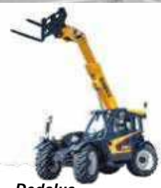
Dedalus Tragkraft: 3–3,4 t Hubhöhe: 6,4–8,7 m Antriebsart: Diesel
