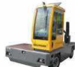
HX 50 Tragkraft: 5 t Hubhöhe: 3,3–7,5 m Antriebsart: Diesel
