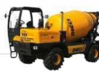
Betonmischer L7000 Wassertankvolumen: 850l Mischkapazität: 5 m³ Antriebsart: Diesel
