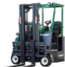
CBE2500–4000 Tragkraft: 2,5–4 t Hubhöhe: 4–7,5 m Antriebsart: Elektro
