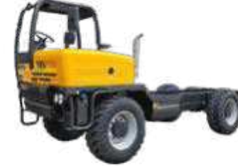
Spezialchassis Nutzlast: 7–12 t Zusatzhydraulik Antriebsart: Diesel
