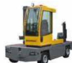
HX 30–40 Tragkraft: 3–4 t Hubhöhe: 3,3–7,5 m Antriebsart: Diesel
