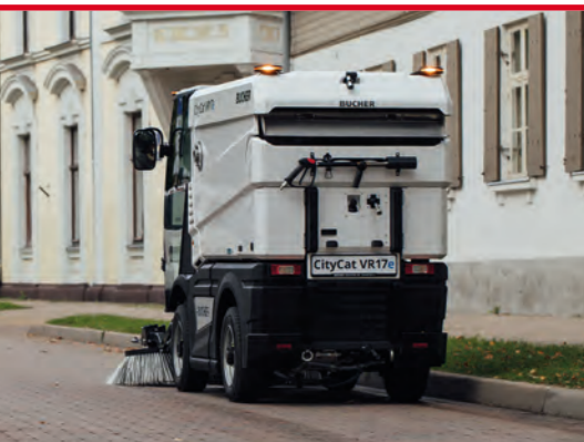
Langlebiger Kehrgutbehälter aus Aluminium
