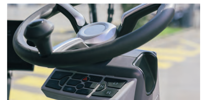
Bedienfeld an der Lenksäule Das Bedienfeld enthält alle fahrrelevanten Tasten, die leicht und schnell zugänglich sind.
