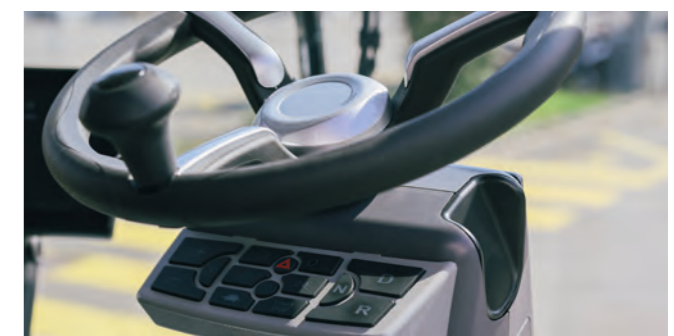
Panneau de commande sur la colonne de direction Le panneau de commande contient tous les boutons nécessaires à la conduite, facilement et rapidement accessibles.
