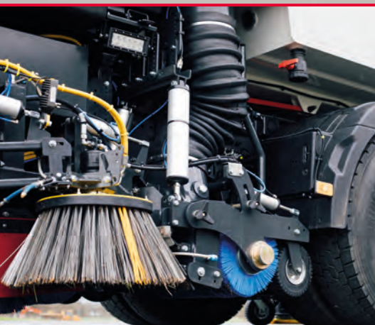
Broomvak-Kehraggregat Für die Hochgeschwindigkeitsaufnahme. Ermöglicht auch das Aufnehmen bei reduzierter Gebläseleistung.
