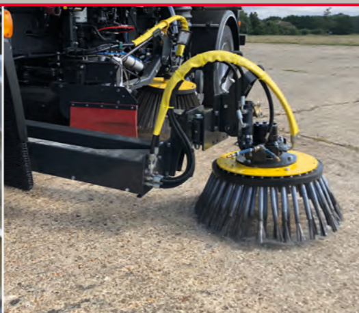
Seitenbesen Optionale Besen hinter dem Vorderrad für grössere Kehrbreite und effektive Unkrautbeseitigung ohne Einsatz von Chemikalien.
