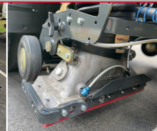
Saugmund Für aggressive Umgebungen. Bietet hochwertigere Stützräder, Stossfänger und Düsenstreben.
