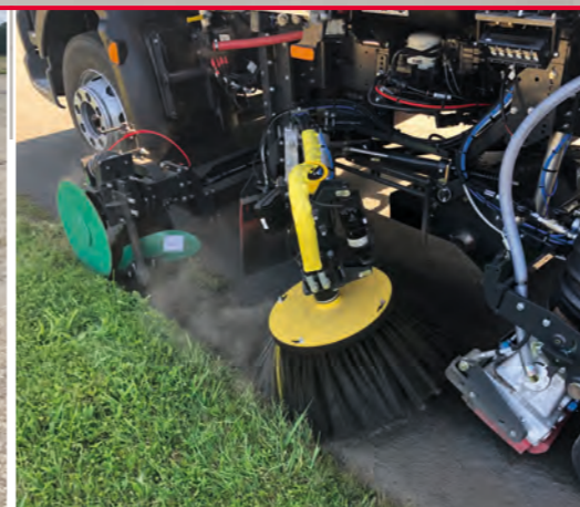
Scheibenschar als Option Ermöglicht das Zurückschneiden von Grasnarbenaufwuchs auf nicht kerbengesäumten Strassen und sorgt für eine saubere Schnittkante an Strassenrändern.
