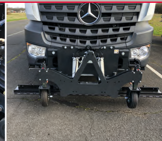
Frontmontierter Magnet Option für das Auffangen und Entfernen von eisenhaltigem Material in der Flughafen- und Industriereinigung.
