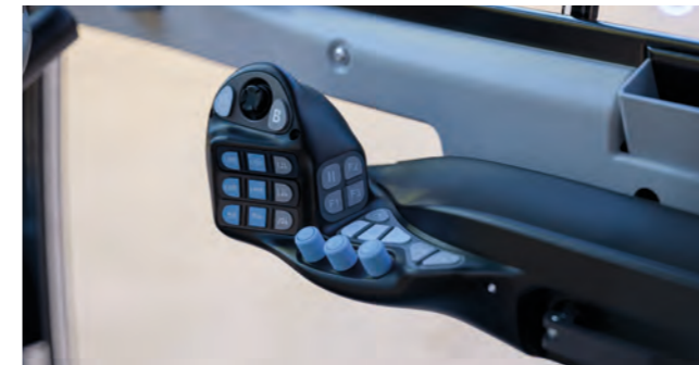
Smart-Con Armlehne Multifunktionale Armlehne mit intelligenter „Startfunktion“ zur einhändigen Bedienung aller Arbeitsfunktionen.
