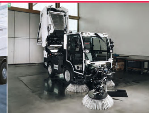
2 m³, einfach zu reinigender Kehrgutbehälter
