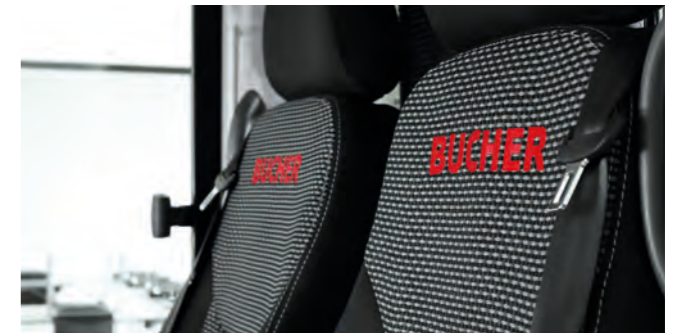
Sitze Die Kabine kann mit zwei vollwertigen Fahrersitzen mit Kopfstützen und 3-Punkt-Sicherheitsgurten ausgestattet werden, um nicht nur ein komfortables Fahrerlebnis zu bieten, sondern auch eine ergonomische Arbeitsstation.
