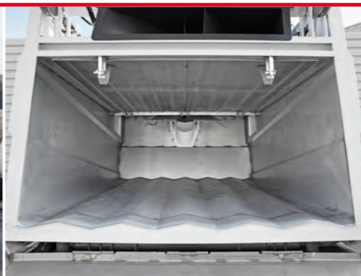
Cuve de 5.6 m 3
