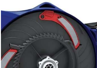
Optimierte Aufrollgeschwindigkeit Eine robuste Zentrifugalbremse in der Trommel sorgt für einen kontrollierten und verlangsamten Einzug.
