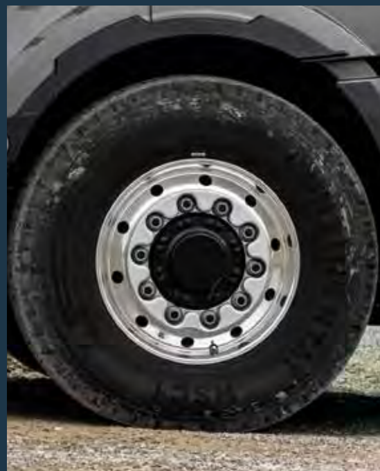
Vorderachse mit hydrostatischen Radnabenmotoren.
