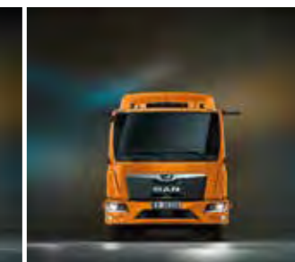
FAHRERHAUS CC: DAS KOMPACTE (schmal, kurz, normalhoch)
