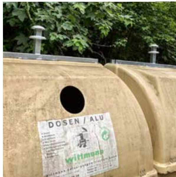
... mit Pilz Aufnahmesystem nach dem Umbau.
