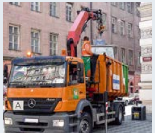
Zum Manövrieren des Krans muss der Fahrer zum Kran hochsteigen.
