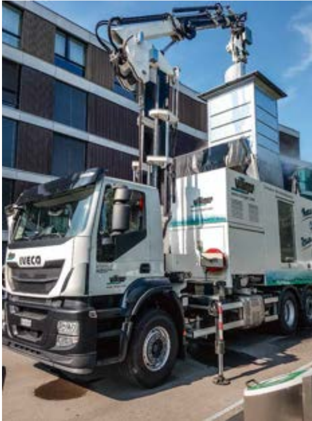
Automatisches Waschen eines Unterflur-Containers in der mobilen Reinigungsanlage.
