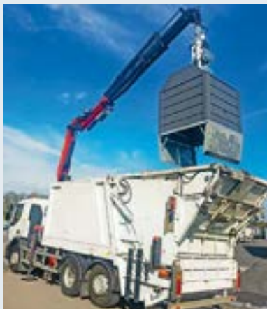
Ein Oberflurcontainer wird heckseitig entleert.
