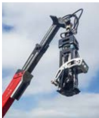
Kran mit Speed-Gripper und Umklappvorrichtung.
