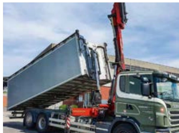
Oder der Kran mit Aufnahmegerät muss vor jedem Kippen der Mulde aus der Gefahrenzone bewegt werden.
