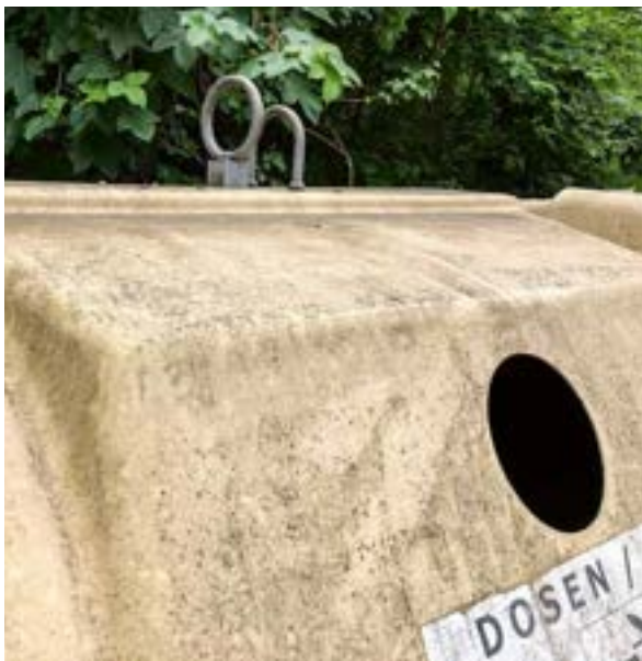
Container mit 2-Haken Aufnahme vor dem Umbau ...
