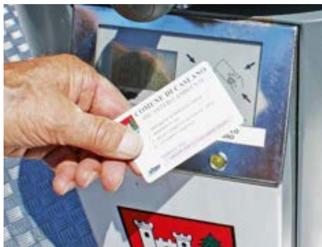
Der Deckel kann nur mittels Access-Card (Zutrittskarte) geöffnet werden.
