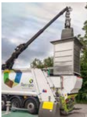
Containerentleerung mittels Dachkran mit Speed-Gripper.
