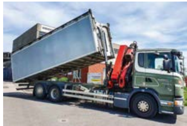
Kran mit Aufnahmegerät muss jedes Mal mit grossem Zeitaufwand zusammengeklappt werden.
