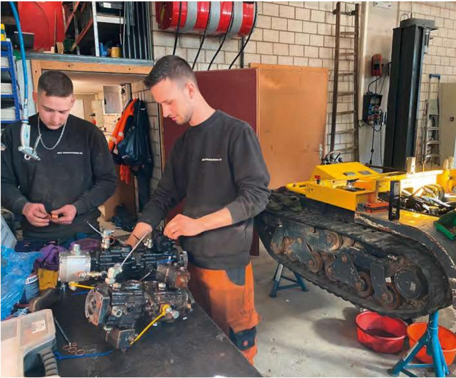
■ Werkstattarbeit: Austausch von Hydraulikpumpe.
