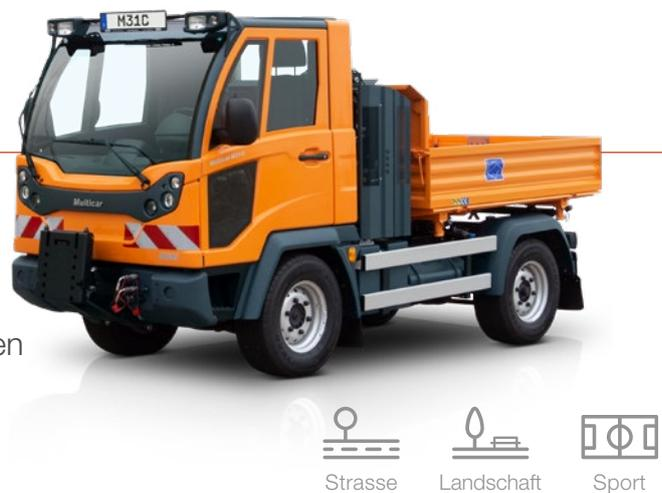
Mechanischer oder stufenloser hydrostatischer Fahrtrieb, Zulässiges Gesamtgewicht bis 5700 kg, Nutzlast bis 2700 kg (Geräteträger, ausstattungsabhängig); Geschwindigkeit Transportmodus 0 bis 90 km/h, je nach Zulassung; Abmessungen (L x B x H) 4180 - 5200 x 1630 - 1730 x 2200 mm
