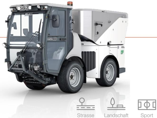
Vollelektrischer Fahrtrieb über 2 Hinterrad-Motoren (2 x 10 kW (S1) / 40 kW Maximalleistung; Leergewichte 2140 kg / 2725 kg / 2845 kg / 2725 kg (GG/2B/3B/CC); Zulässige Gewichte 3500 kg / 1700 kg / 2400 kg (ZGG/VA/HA); Abmessungen (L x B x H) 3830 x 1210 x 1970 mm
