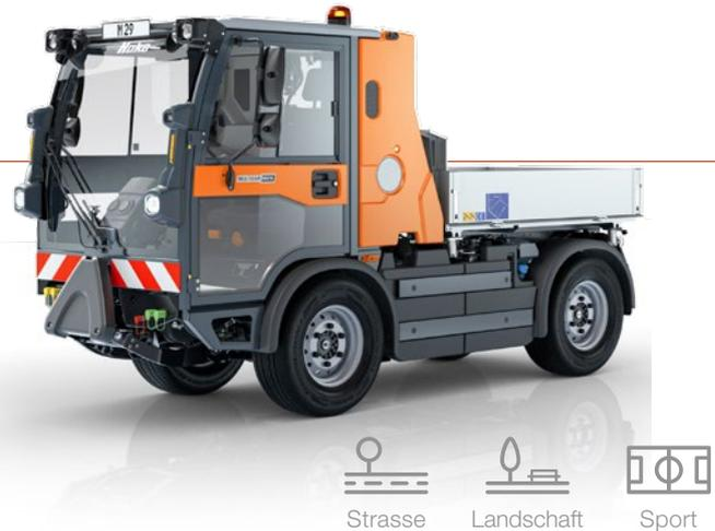
Stufenloser hydrostatischer Fahrtrieb, elektronisch gesteuert, mit 2 unter Last schaltbaren Fahrstufen; Zulässiges Gesamtgewicht 6,0t, Nutzlast bis 3,2t (Geräteträger, ausstattungsabhängig); Geschwindigkeit Transportmodus 0 bis 62 km/h, stufenlos; Geschwindigkeit Arbeitsmodus 0 bis 25 km/h, stufenlos
