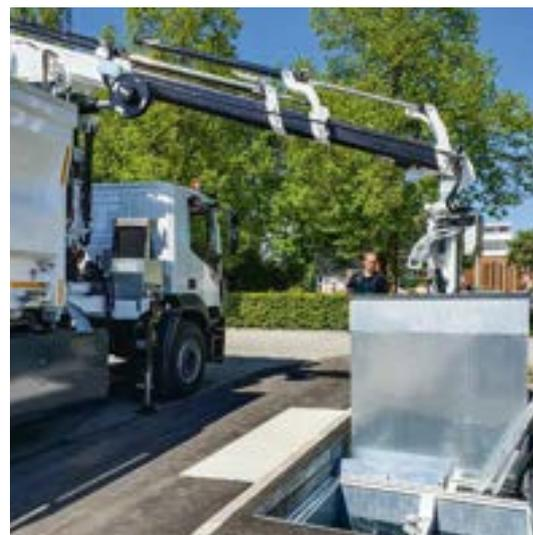
Vidange du conteneur en acier d'une contenance de 6 m³ par un Speed-Waste-Lifter.
