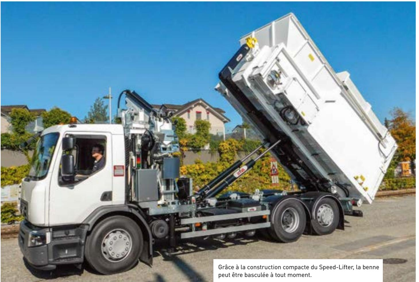
Grâce à la construction compacte du Speed-Lifter, la benne peut être basculée à tout moment.
