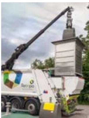
Vidange de conteneur à l'aide d'une grue en toit avec Speed-Gripper.
