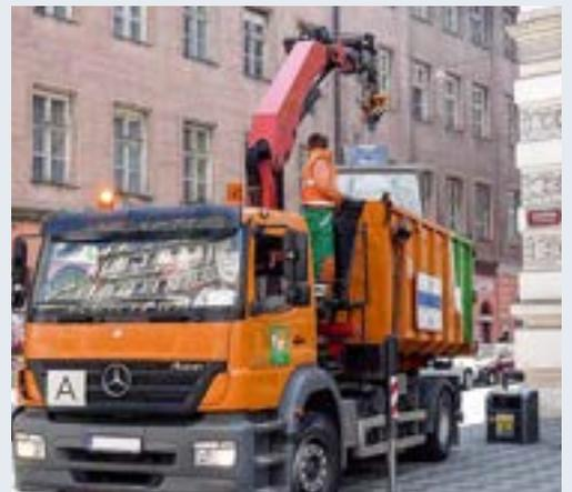
Pour manœuvrer la grue, le conducteur doit monter au niveau de la grue.
